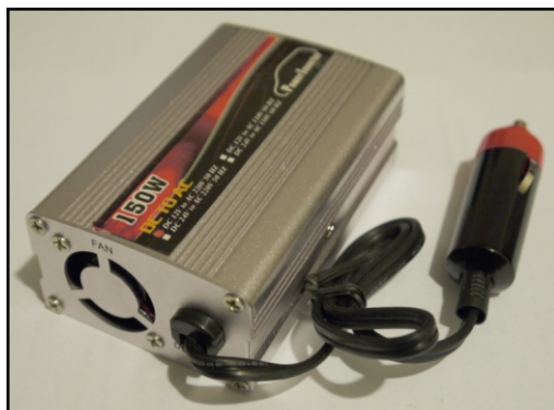
konvertor napona 24/220V za automobil
