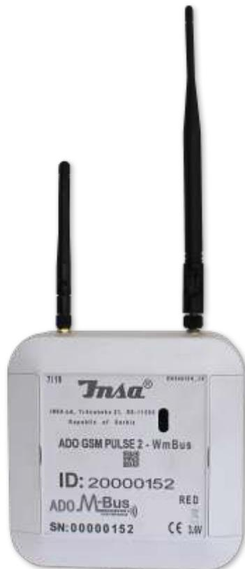
**ADO GSM2 wmbus** uređaj namenjen je za transfer očitanih stanja na udaljeni računar putem GSM/GPRS mreže.
