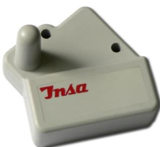
ADO RF-24 je jedini uređaj ADO Sistema koji radi na frekvenciji od 2,4 GHz. Uređaj je pogodan za aplikacije gde je potrebna velika brzina očitavanja (praćenje potrošnje u realnom vremenu). Zbog nešto manjeg dometa nije pogodan za postavljanje u šahtovima već je namenjen ugradnji u nadzemnim ormanima gde se uz pomoć ADO Gateway-a očitavanje može potpuno automatizovati i iz udaljenog centra na računaru pratiti potrošnja u realnom vremenu uz osvežavanje podataka na svake 4 sekunde.
