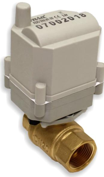
ADO M-Bus Valve je ventil namenjen automatskom daljinskom zatvaranju i otvaranju gde se komanda zatvori/otvori šalje putem kabla, tj. kroz M-Bus mrežu. Ventil ima rasprostranjenu primenu u u sistemima za snabdevanje vodom i gasom, industriji, prehrambenoj industriji kao i u sistemima za navodnjavanje. Ventil se može koristiti za kontrolu protoka bilo kojeg fluida pod uslovom da nije hemijski agresivan, da njegova temperatura ne prelazi 90°C i pritisak od 10 bara.
