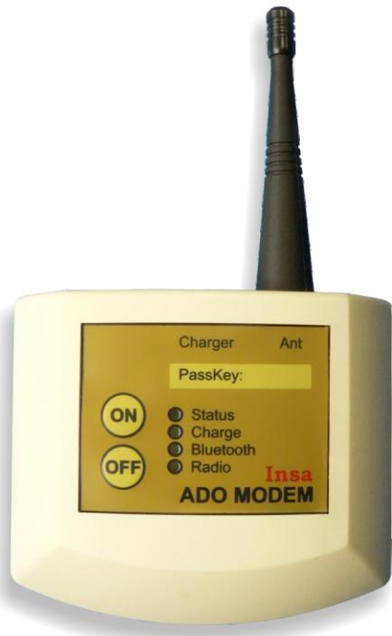
ADO Modem je uređaj namenjen bežičnom daljinskom očitavanju ADO modula na vodomerima. Modem služi kao veza za komunikaciju između radio modula na vodomerima i ručnog terminala.
